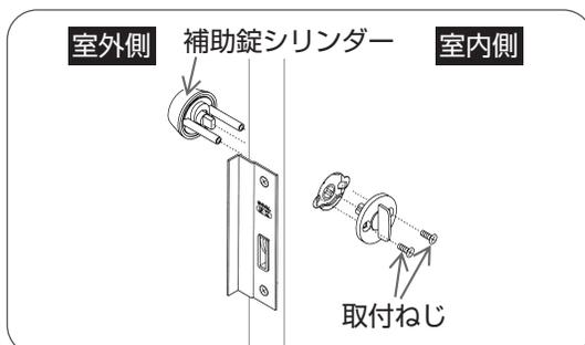
室内側からプラスドライバーでシリンダーの取付ねじをはずし、サムターンおよびシリンダーをはずす。
