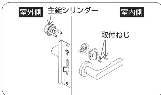
室内側からプラスドライバーでシリンダーの取付ねじをはずし、サムターンおよびシリンダーをはずす。
