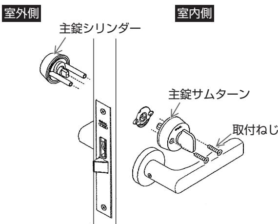
室内側からプラスドライバーでシリンダーの取付ねじをはずし、サムターンおよびシリンダーをはずす。
