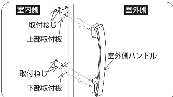
室内側からプラスドライバーで取付板の取付ねじをはずし、取付板と室外側ハンドルをはずす。
