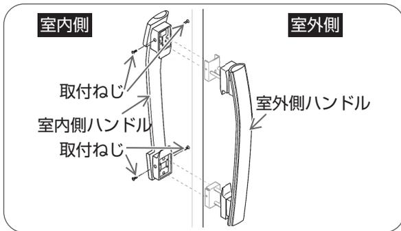
室内側よりプラスドライバーで室内側ハンドルの取付ねじをはずし、室内側ハンドルをはずす。
