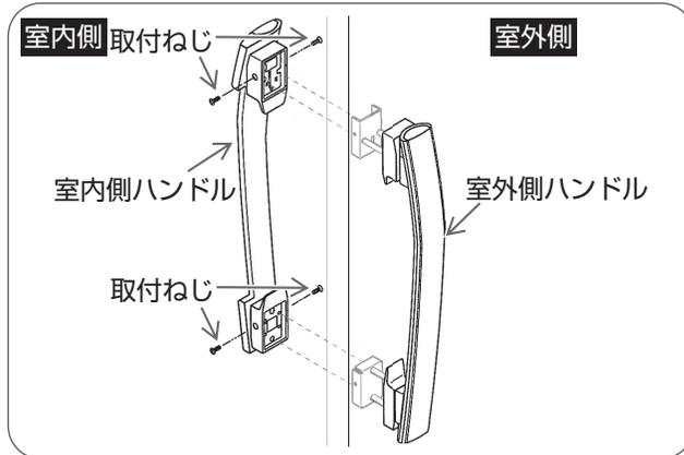
室内側ハンドルを取付板に差し込み、プラスドライバーで取付ねじをしめる。
