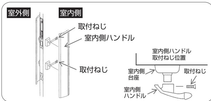
室内側からプラスドライバーで室内側ハンドルの取付ねじをはずし、ハンドルをはずす。
