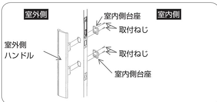
室内側からプラスドライバーで室内側台座の取付ねじをはずし、ハンドルをはずす。
