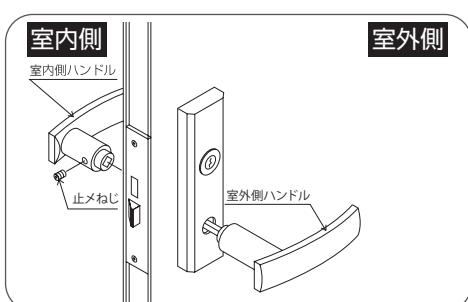
プラスドライバーで室内側ハンドルの止メねじをはずし、室内側ハンドルおよび室外側ハンドルをはずす。
