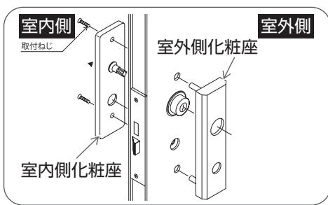
室内側からプラスドライバーで取付ねじをはずし、室内側化粧座および室外側化粧座をはずす。
