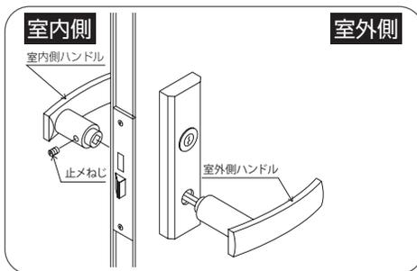
プラスドライバーで室内側ハンドルの止めねじをはずし、室内側ハンドルおよび室外側ハンドルをはずす。
