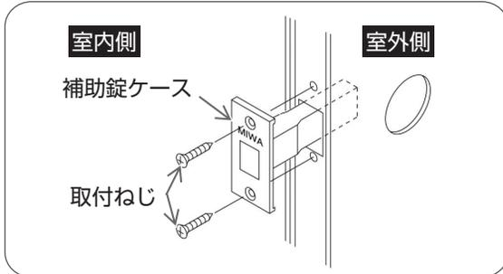
補助錠ケースを取付穴に差し込み、プラスドライバーで補助錠ケースの取付ねじをしめる。
