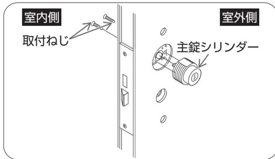
室内側からプラスドライバーで主錠シリンダーの取付ねじをはずし、主錠シリンダーをはずす。
