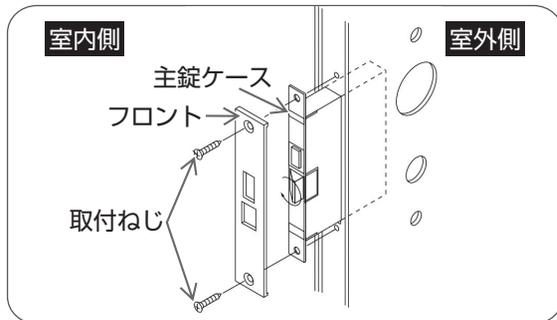
プラスドライバーで主錠ケースの取付ねじをはずし、主錠ケースをはずす。
