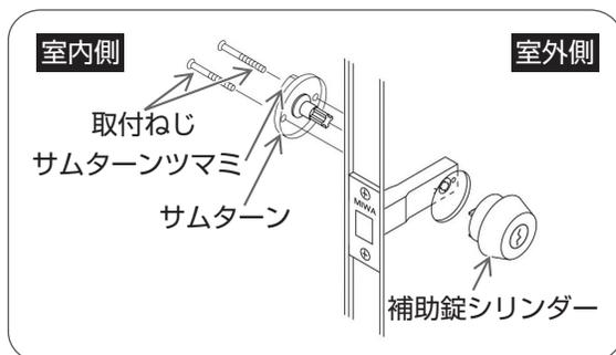
室内側からプラスドライバーで補助錠シリンダーの取付ねじをはずし、補助錠シリンダーをはずす。
