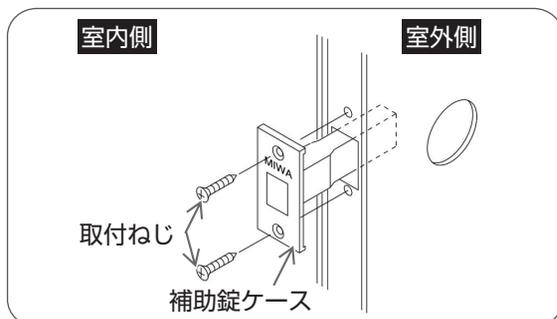
プラスドライバーで補助錠ケースの取付ねじをはずし、補助錠ケースをはずす。
