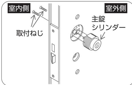
室内側からプラスドライバーで主錠シリンダーの取付ねじをはずし、主錠シリンダーをはずす。
