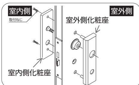
室内側からプラスドライバーで取付ねじをはずし、室内側化粧座および室外側化粧座をはずす。
