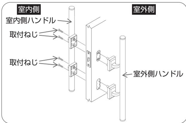
室内側より取付ねじをプラスドライバーではずし室内側ハンドルおよび室外側ハンドルをはずす。
