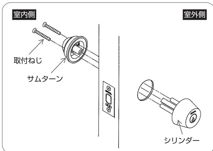
室内側からプラスドライバーでシリンダー取付ねじをはずし、サムターンおよびシリンダーをはずす。
