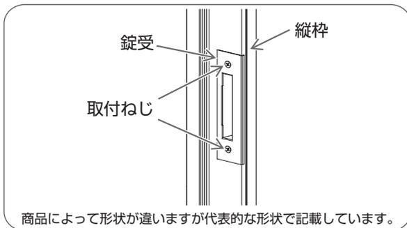
プラスドライバーで上下の取付ねじゆるめる。
