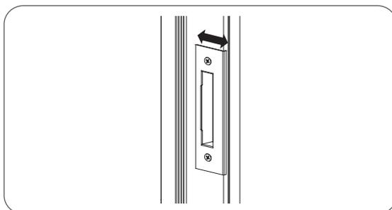
プラスドライバーで取付ねじをゆるめて左右方向に錠受を調整し、再度ねじをしめる。
