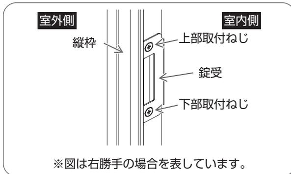
プラスドライバーで上部および下部取付ねじをしめる。
