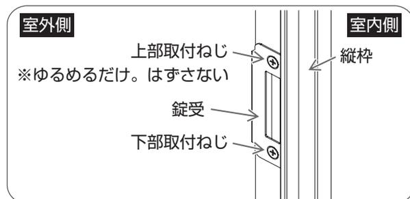
プラスドライバーで下部取付ねじをはずし、上部取付ねじをゆるめる。
