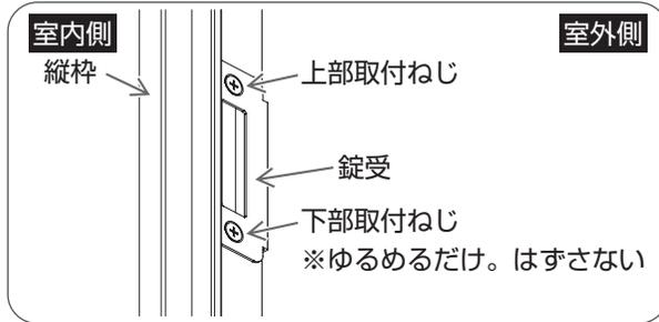
プラスドライバーで上部取付ねじをはずし、下部取付ねじをゆるめる。
