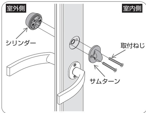
プラスドライバーでサムターン側の取付ねじをはずし、サムターンとシリンダーを取りはずす。
