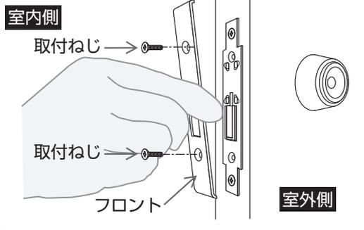
フロントを錠ケースの取付穴に合わせ、プラスドライバーで取付ねじをしめる。
