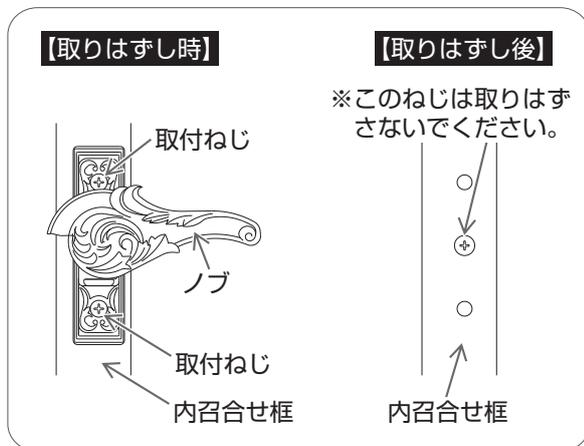
クレセントのノブを水平にし、プラスドライバーでクレセントの取付ねじをはずし、クレセントをはずす。
