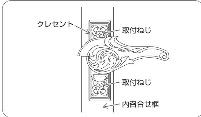
クレセントを取付穴に合わせ、プラスドライバーで取付ねじをしめる。
