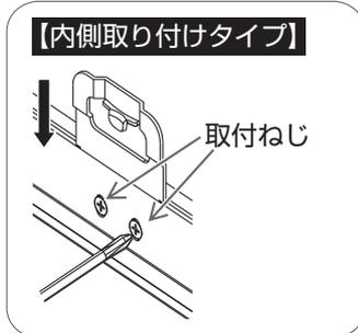
クレセント受を窓本体に差し込み、プラスドライバーで取付ねじをしめる。
