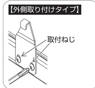
クレセント受を取付穴に合わせ、プラスドライバーで取付ねじをしめる。
