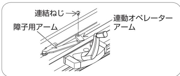
障子を保持しながらプラスドライバーで障子用アームと連動オペレーターアームの連結ねじをはずす。
