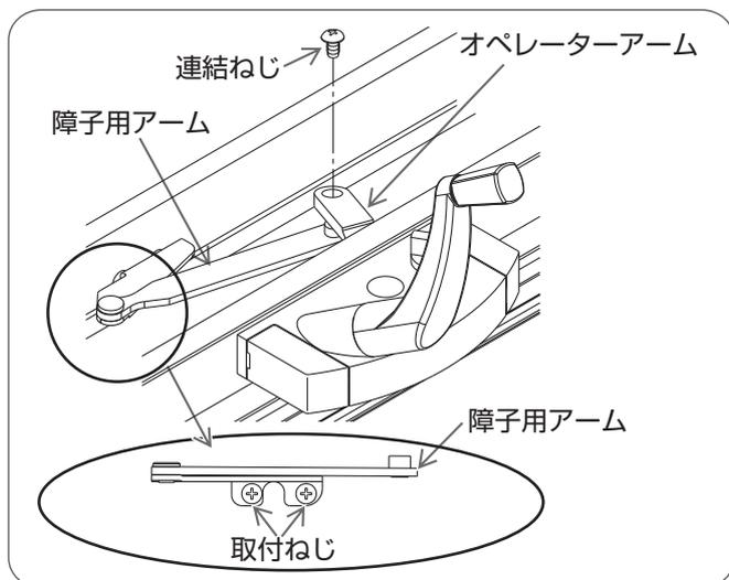
ハンドルを操作し、障子用アームとオペレーターアームを合わせ、プラスドライバーで連結ねじをしめる。
