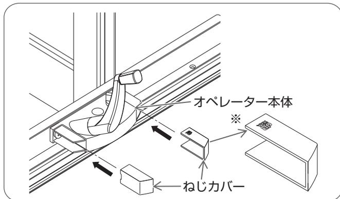
オペレーター本体にねじカバーを取り付ける。
