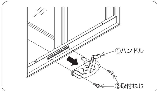
プラスドライバーで取付ねじをはずし、オペレーターハンドルをはずす。
