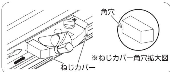
マイナスドライバーをねじカバーの角穴に差し込み、ねじカバーをはずす。
