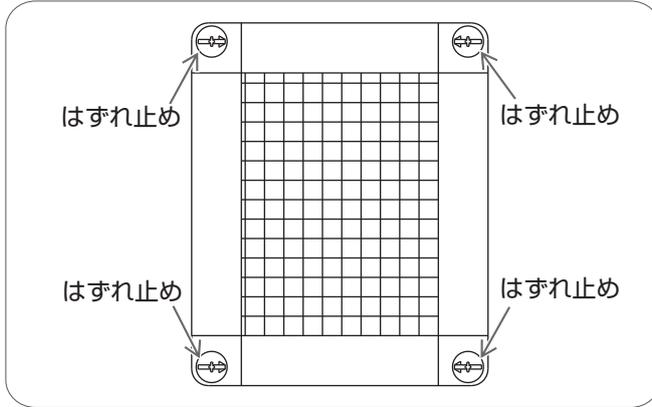
網戸の上下左右（4ヶ所）のはずれ止めのツマミの溝が横になり、網戸から引寄せ片が出ていない（解除状態）ことを確認する。
