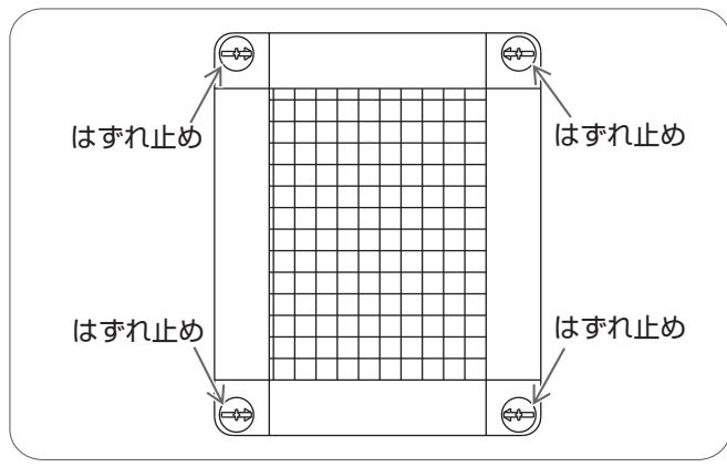
網戸の上下左右（4ヶ所）のはずれ止めのツマミの溝が横になり、網戸から引寄せ片が出でていない（解除状態）ことを確認する。
