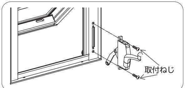
障子を保持しながらオペレーター ハンドルを取付穴に差し込み、プラスドライバーで取付ねじをしめる。
