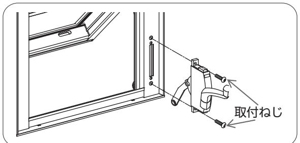
プラスドライバーで取付ねじをはずし、オペレーター ハンドルをはずす。
