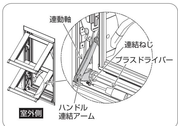
ハンドルを操作し、運動軸とオペレーターアームを合わせ、プラスドライバーで連結ねじをしめる。
