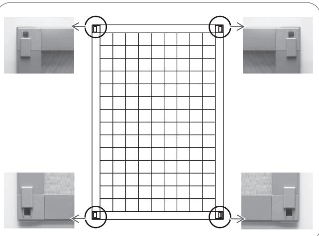
網戸の上下左右（4ヶ所）のはずれ止めが解除されていることを確認する。
