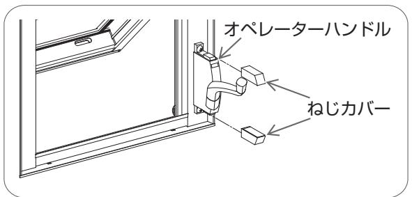
マイナスドライバーを角穴に差し込み、ねじカバーをはずす。(下図参照)
