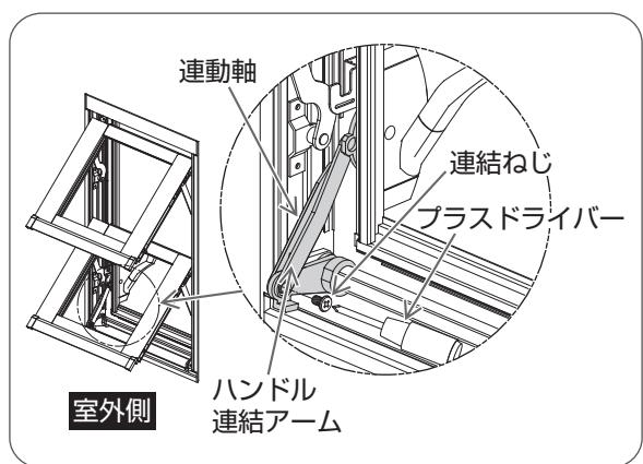
障子を保持しながらプラスドライバーで運動軸とハンドル連結アームの連結ねじをはずす。
