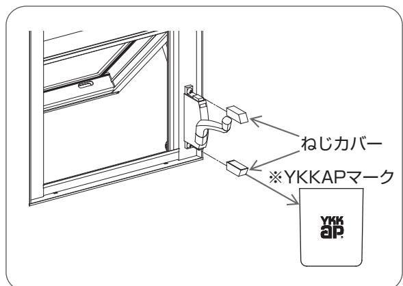
オペレーター本体にねじカバーを取り付ける。
