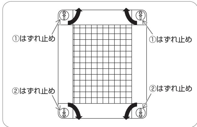
①網戸を枠に押し当て、プラスドライバーで上の左右にあるはずれ止めのツマミを90度回しツマミの溝を縦にする。
