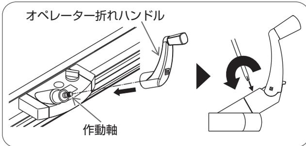
オペレーター折れハンドルを作動軸に差し込み、プラスドライバーで止めねじをしめる。
