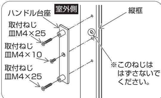
室外側よりプラスドライバーでハンドル台座の取付ねじをはずし、ハンドル台座をはずす。
