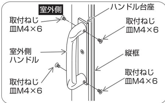
室外側よりハンドルをハンドル台座のねじ柱に差し込み、プラスドライバーで取付ねじをしめる。
