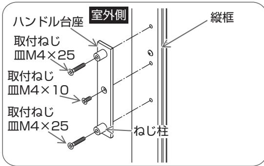
室外側よりハンドル台座を取付穴に合わせ、プラスドライバーで取付ねじをしめる。
