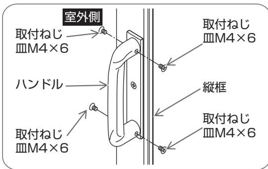
室外側よりプラスドライバーでハンドルの取付ねじをはずし、ハンドルをはずす。
