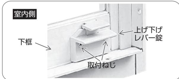
室内側より上げ下げレバー錠を取付穴に差し込み、プラスドライバーで取付ねじをしめる。
