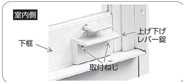
室内側よりプラスドライバーで上げ下げレバー錠の取付ねじをはずし、上げ下げレバー錠をはずす。
