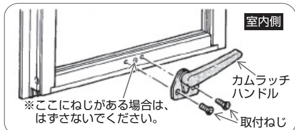
室内側よりプラスドライバーでカムラッチハンドルの取付ねじをはずし、カムラッチハンドルをはずす。
