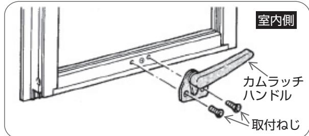
室内側よりカムラッチハンドルを取付穴に合わせ、プラスドライバーで取付ねじをしめる。
