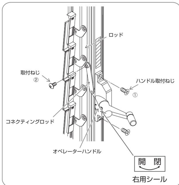
① ガラスを閉めた状態でオペレーターハンドルを取付穴に合せる。
