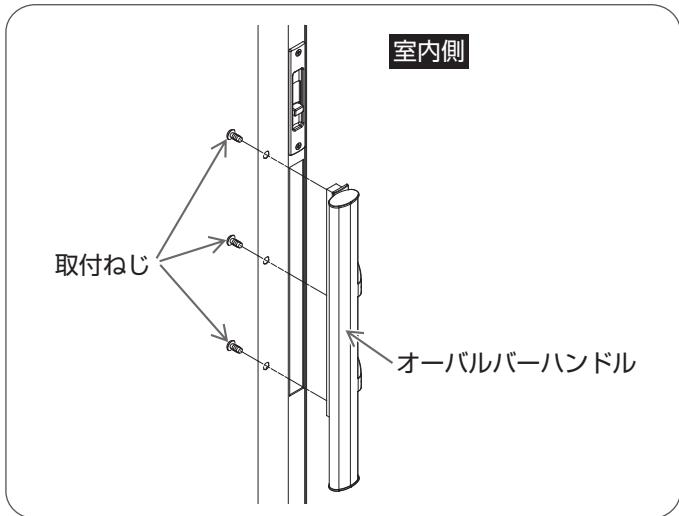
ハンドルを取付穴に差し込み、プラスドライバーで取付ねじをしめる。
