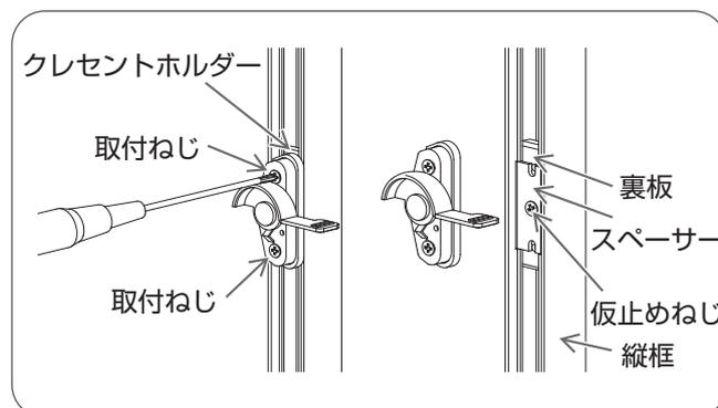
①クレセントのノブを水平に回しプラスドライバーで上部および下部の取付ねじをはずしてクレセントとクレセントホルダーをはずします。
