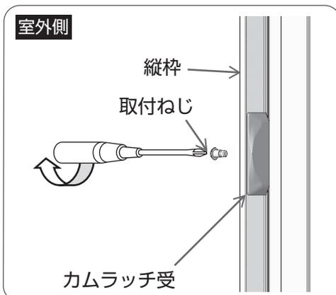
プラスドライバーで縦枠の室外側から取付ねじをはずし、カムラッチ受をはずす。
