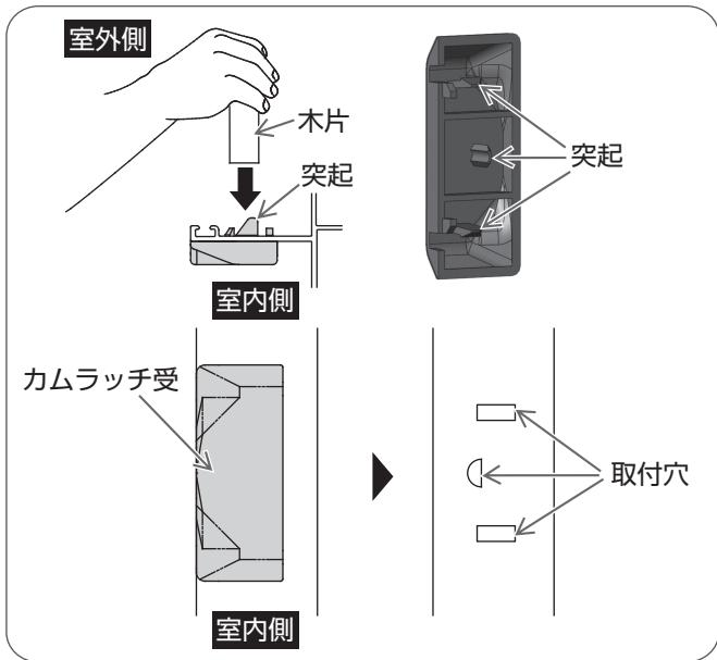
室外側からカムラッチ受取付裏面に出ているカムラッチ受の突起を木片で押し、カムラッチ受をはずす。
