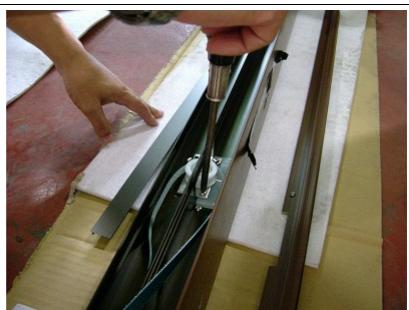
No. 18 右の写真のいちばん左側のねじは、 裏板取り付けねじなので、取り外さないように 注意の事。 (たて框内に裏板が落ちてしまう)
