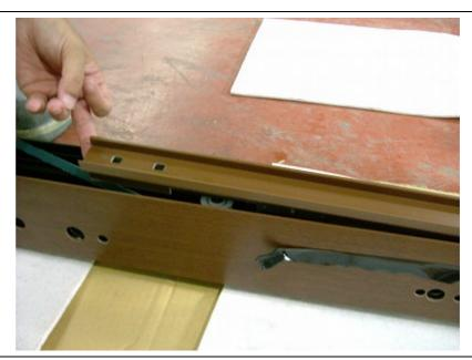
No. 13 樹脂レールカバーを取りかしたところ。 戸先側樹脂レールカバーには、 補強金具がついている。 (右の丸囲み部)
